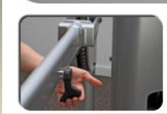
**El embrague del detalle permite que de modo autónomo e independiente se puedan accionar los brazos a cualquiera de las posiciones de trabajo.**
